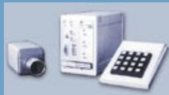
So fing alles an: Die Eigenentwicklung ibea Logic1 zur optischen Inspektion von Massenprodukten 1991
