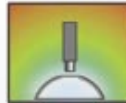
Imager CFL-LD für tiefgezogene Teile bis Ø 120 mm und ca. 150 mm Höhe
