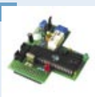
Überwachungselektro- nik für Auswerfer zur Funktionsüberwa- chung bei bis zu 3 möglichen Auswerfern.
