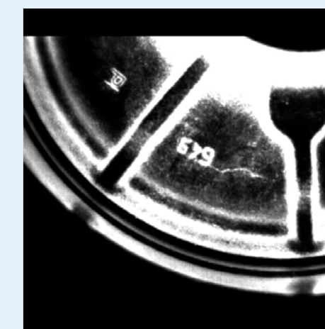
Riss-Erkennung bei einer Bremsscheibe per Wärmefluss-Thermografie
