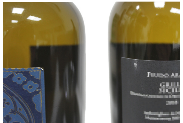
Produktionsfehler am Etikett: umgeknicktes Etikett oder Kratzer im Design
