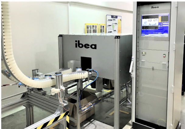
6-Kamera-System mit Förderband und E-Rack
