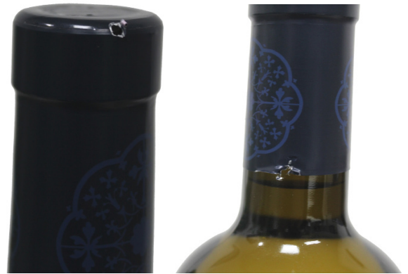
Produktionsfehler am Flaschenhals: Kratzer am Verschluss oder Kapselriß
